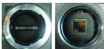
Một dây gồm 64 điểm cảm ứng ở vòi LINE SENSOR
